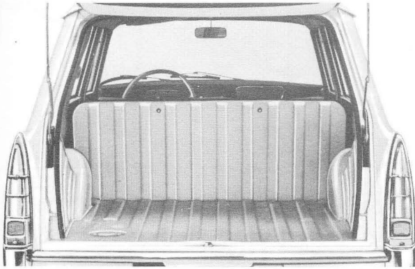
Banquette AR avec assise basculée et dossier rabattu
