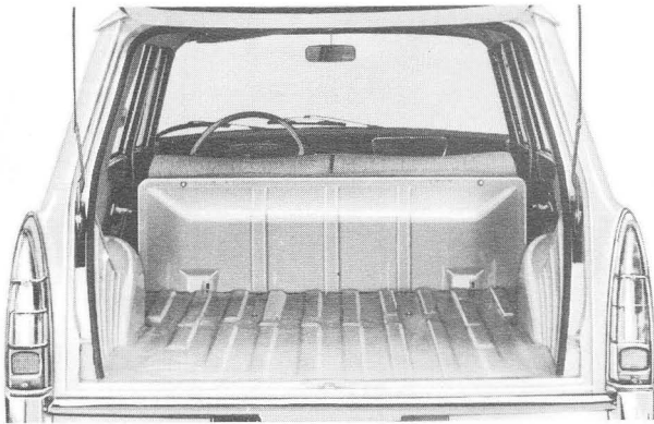
Banquette AR avec tôle-support du dossier rabattue sur l'assise
