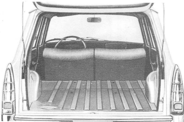
Banquette AR avec tôle-support du dossier rabattue sur l'assise
